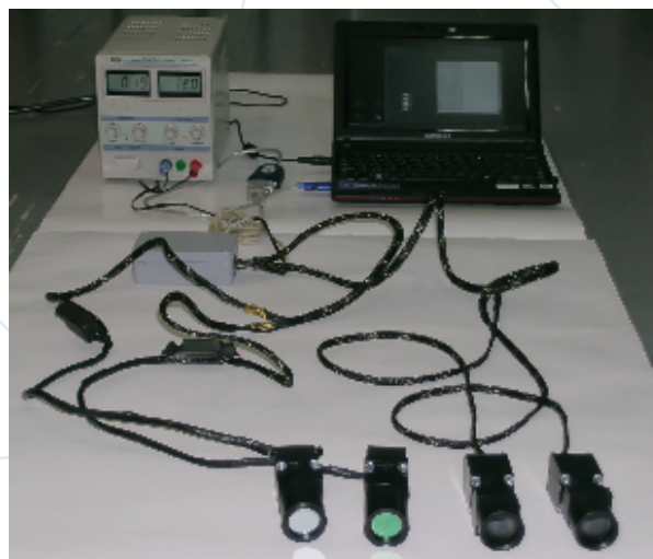
Rys.2 Zespół czterech radiometrów przed integracją na pokładzie samolotu
