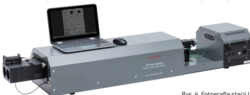
Rys. 4. Fotografia stacji LTE do badań dalmierzy laserowych
