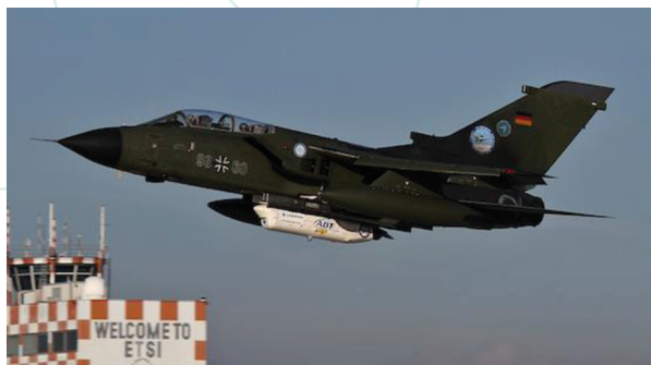
Rys. 9. Stacja TOGS (zdjęcie lewe), podwieszony do myśliwca Tornado układ umożliwiający komunikację optyczną ze stacją bazowaną TOGS (zdjęcie prawe)
