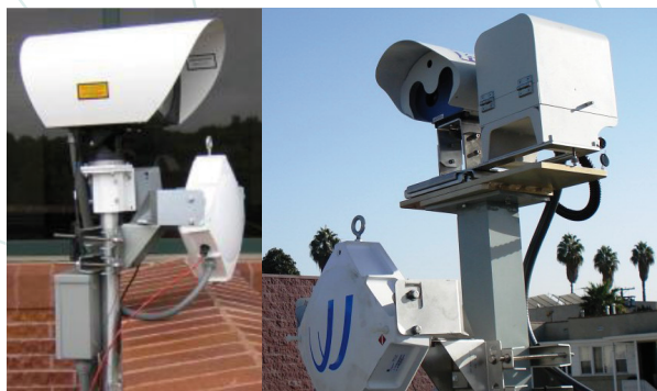
Rys. 10. Przykłady rozwiązań hybrydowych FSO/RF
