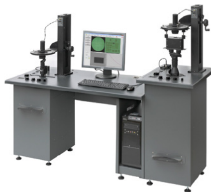
Rys. 3. Fotografia zestawu Nimax B5 do badań przyrządów noktowizyjnych
