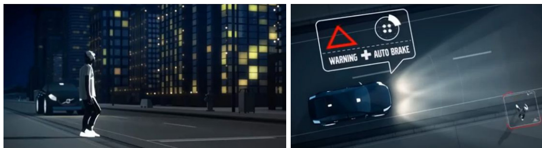
Rys. 5. Ilustracja działania systemu przedkolizyjnego z technologią wykrywania pieszych na drodze [12]
