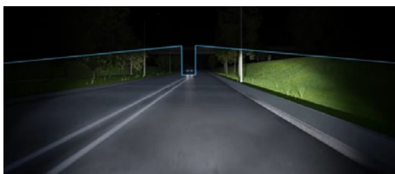
Rys. 8. Ilustracja działania system aktywnych świateł drogowych [12]
