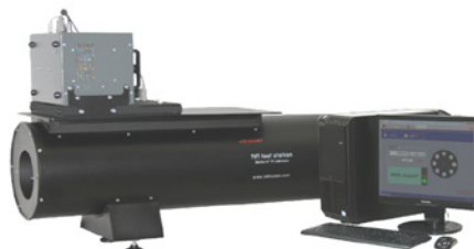
Rys. 2. Fotografia zestawu TVT150X do badań kamer wizyjnych
