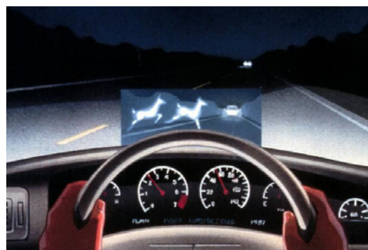
Rys. 6. Ilustracja działania asystenta jazdy nocnej [13]
