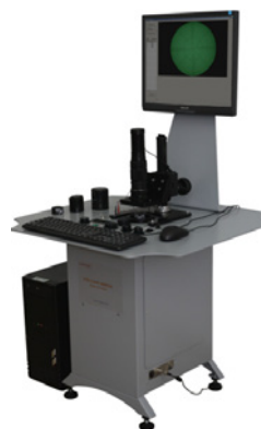
Rys. 4. Fotografia zestawu ITS-IP do badań wzmacniaczy obrazu
