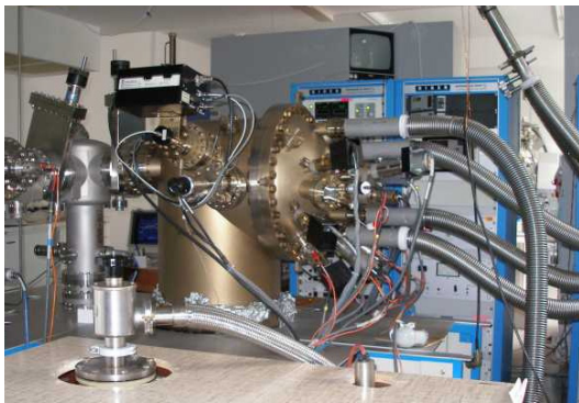
Rys.1. Urządzenie RIBER 32P do krystalizacji heterostruktur metodą MBE
