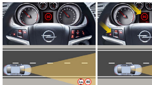
Rys. 4. Ilustracja działania systemu rozpoznawania znaków drogowych [10]
