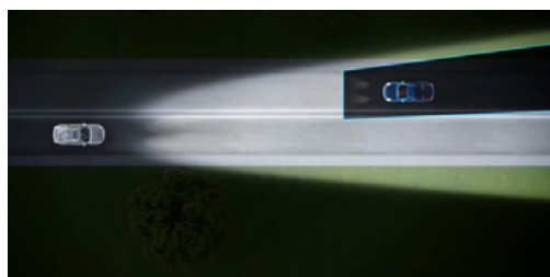
Rys. 8. Ilustracja działania system aktywnych świateł drogowych [12]
