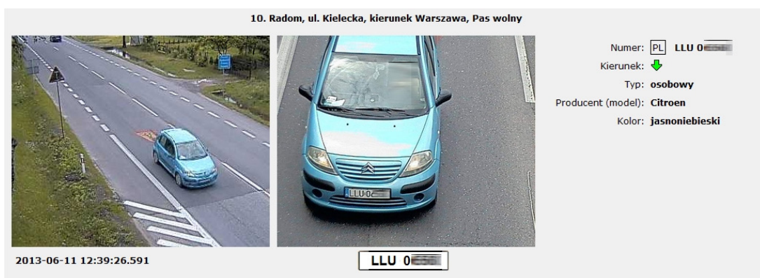
Rys. 1. Identyfikacja pojazdów w systemie NeuroCar firmy Neurosoft [5]
