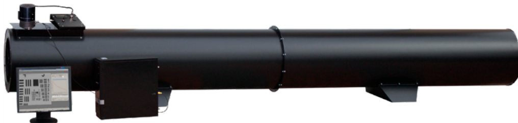
Rys. 9. Zestaw OTEC do badań wielkogabarytowych obiektów optycznych
