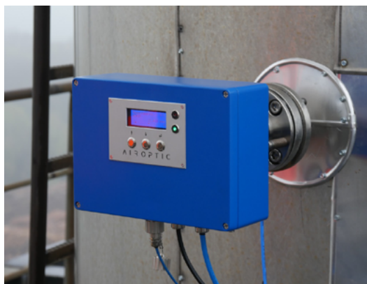
Rys. 1: System GasEye cross duct HCHO firmy Airoptic Sp. z o.o. monitorujący emisję formaldehydu z procesu przemysłowego do atmosfery
